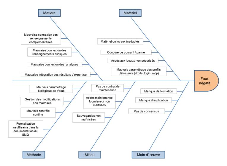
Dans un second temps, la méthode AMDEC (Analyse des Modes de Défaillance, de leurs Effets et de leur Criticité) permet de classifier les différentes causes identifiées ci-avant en termes de criticité (gravité, fréquence et détectabilité) en regard des moyens de maîtrise mis en place.
